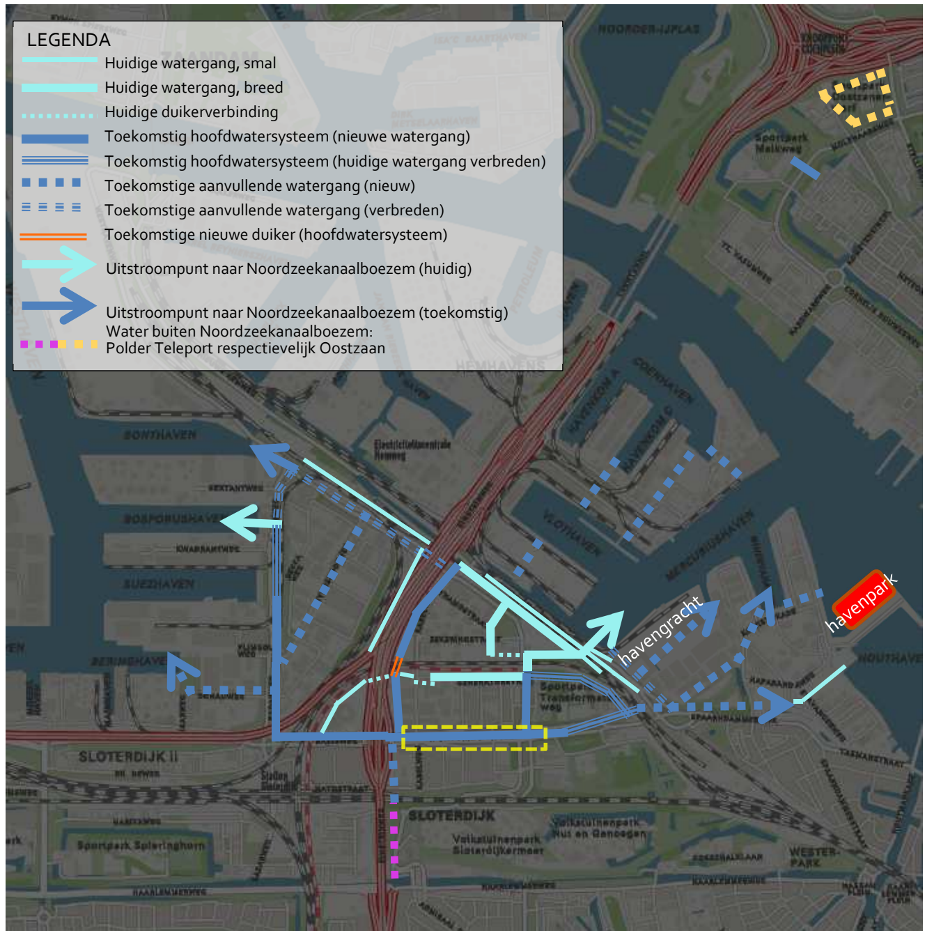
Figuur 9 Eén van de mogelijkheden voor toekomstige waterstructuur (eindbeeld). Het gele gestippelde kader zoomt in op de watergang die gepland is in Sloterdijk I-Zuid.
