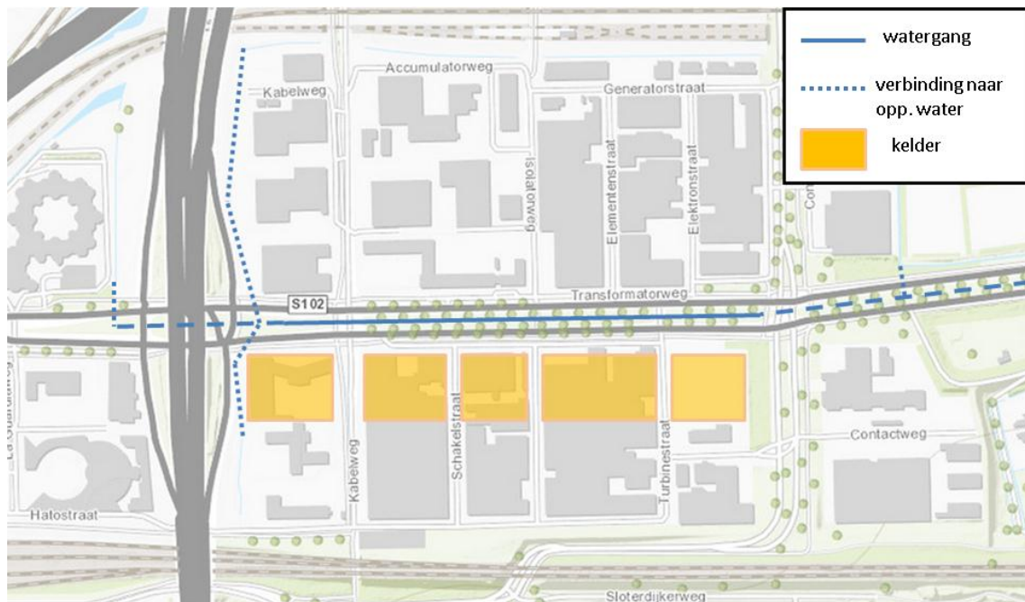
Figuur 3-1: Indicatie uitwerking scenario's met nieuwe watergang Transformatorweg (scenario 2) en kelders (scenario 3)
