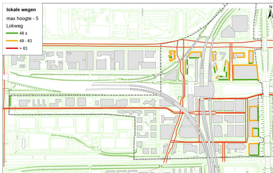
figuur 5 wegverkeerslawaai lokale wegen geluidsbelasting in dB op maximale gebouwhoogte minus 5 m
