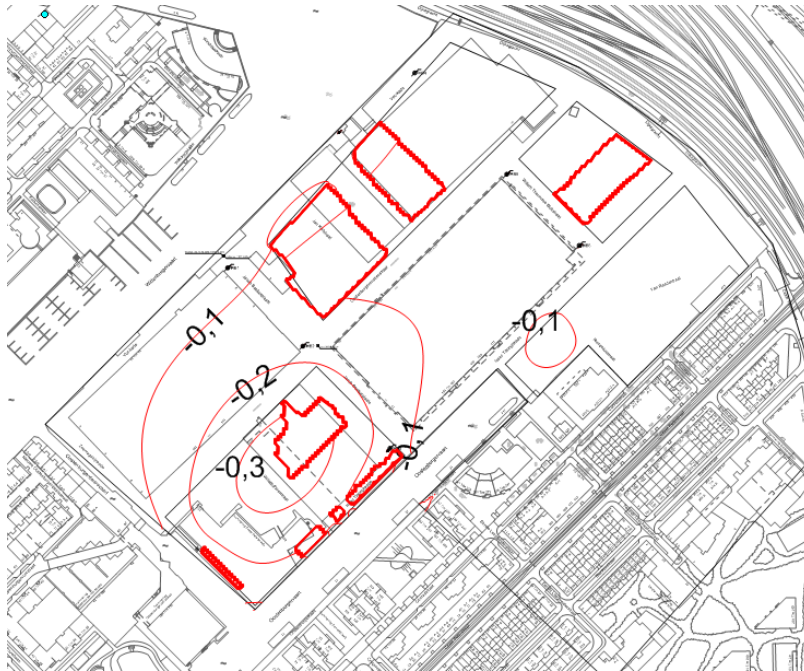
Figuur 10: Scenario 2 berekende grondwaterstandsverandering t.o.v. scenario 1 met waterdoorlatende kades [in meters]
