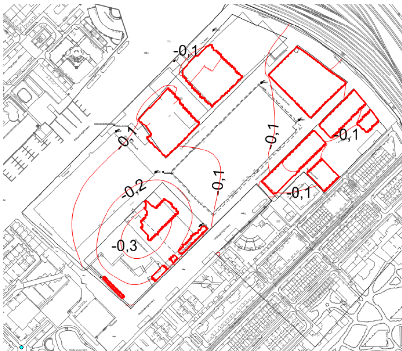
Figuur 11: Scenario 3 berekende grondwaterstandsverandering t.o.v. scenario 1 met waterdoorlatende kades [in meters]
