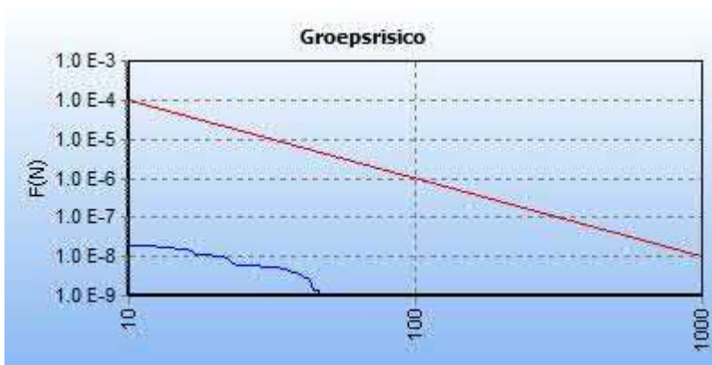
5.2 Figuur 5.2 FN curve voor 5937_leiding-A-807-deel-1 van N.V. Nederlandse Gasunie voor de kilometer tussen stationing 3720.00 en stationing 4720.00
