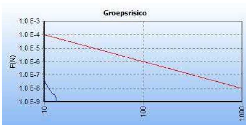
5.2 Figuur 5.2 FN curve voor 5855_leiding-W-534-01-deel-1 van N.V. Nederlandse Gasunie voor de kilometer tussen stationing 22210.00 en stationing 23210.00
