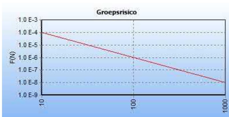
5.4 Figuur 5.4 FN curve voor 5855_leiding-W-534-01-deel-3 van N.V. Nederlandse Gasunie voor de kilometer tussen stationing 0.00 en stationing 0.00
