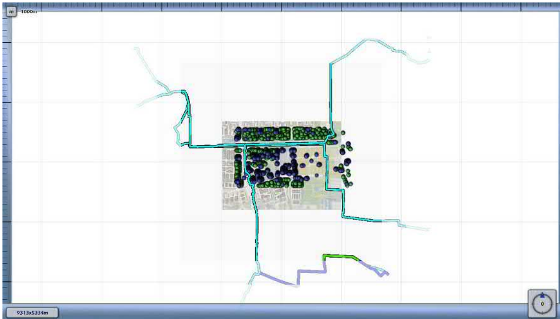
4.8 Figuur 4.8 Groepsrisico screening voor 5864_leiding-W-540-03-deel-1_incl verl van N.V. Nederlandse Gasunie
