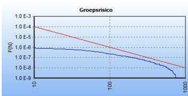
5.5 Figuur 5.5 FN curve voor 5937_leiding-W-540-03-deel-1_excl verl van N.V. Nederlandse Gasunie voor de kilometer tussen stationing 1430.00 en stationing 1930.00
