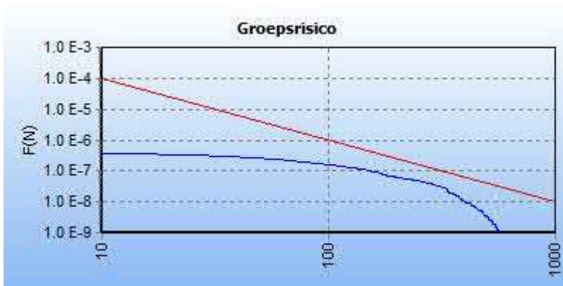
5.2 Figuur 5.2 FN curve voor 5937_leiding-A-807-deel-1 van N.V. Nederlandse Gasunie voor de kilometer tussen stationing 3720.00 en stationing 4720.00
