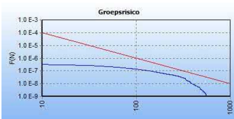
5.2 Figuur 5.2 FN curve voor 5855_leiding-W-534-01-deel-1 van N.V. Nederlandse Gasunie voor de kilometer tussen stationing 22210.00 en stationing 23210.00
