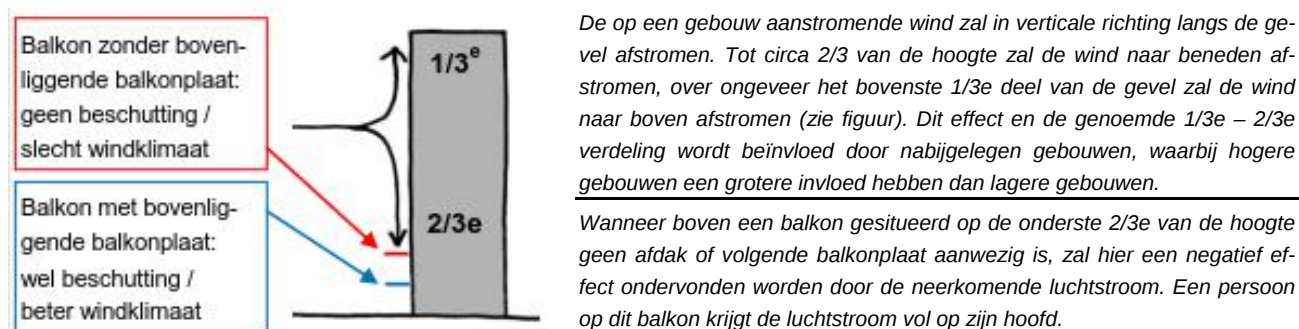
Figuur 5.5: Verticale afstroming en verticale afscherming en het effect op het windklimaat op de balkons
