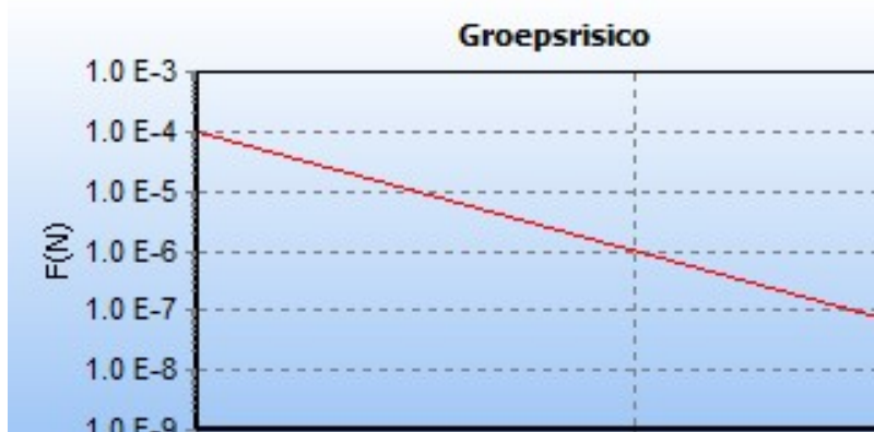
5.7 Figuur 5.7 FN curve voor 6637_leiding-W-540-07-deel-1 van N.V. Nederlandse Gasunie voor de kilometer tussen stationing 3790.00 en stationing 4790.00
