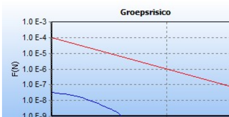
5.7 Figuur 5.7 FN curve voor 6637_leiding-W-540-07-deel-1 van N.V. Nederlandse Gasunie voor de kilometer tussen stationing 3790.00 en stationing 4790.00
