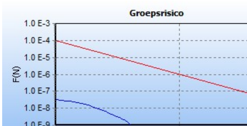
5.7 Figuur 5.7 FN curve voor 6637_leiding-W-540-07-deel-1 van N.V. Nederlandse Gasunie voor de kilometer tussen stationing 3790.00 en stationing 4790.00
