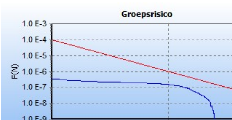
5.5 Figuur 5.5 FN curve voor 6637_leiding-W-540-02-deel-1 van N.V. Nederlandse Gasunie voor de kilometer tussen stationing 0.00 en stationing 300.00
