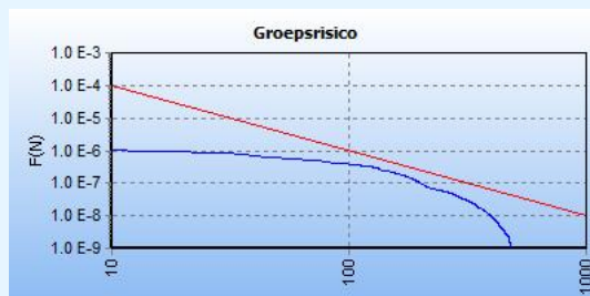
figuur 4b: fN-curve groepsrisico buisleiding W-540-01 planrealisatie
