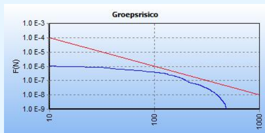
figuur 4a: fN-curve groepsrisico buisleiding W-540-01 huidig/autonoom
