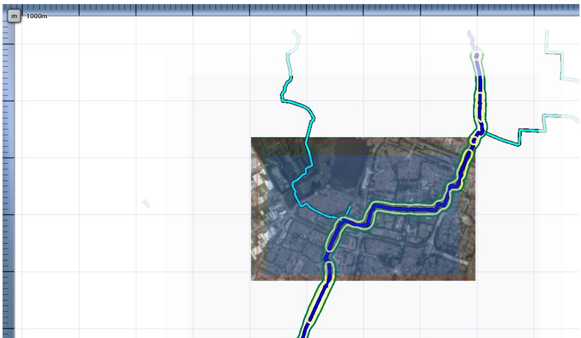
3.4 Figuur 3.4 Plaatsgebonden risico voor 6637_leiding-W-540-01-deel-1 van N.V. Nederlandse Gasunie
