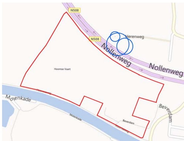
Afbeelding 5 De PR 10^{-6} contouren voor het vulpunt (45 m), het reservoir (25 m) en de afleverzuil (15m).
