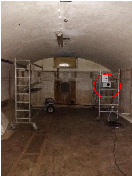
Figuur 4-2. Locatie van de Batcorder tijdens de winter 2017-2018. De Batcorder (in de rode cirkel) lag in een harde kunststoffen behuizing op een rolsteiger. De microfoon was gericht op de doorgang van de verbindingsgang met invliegopeningen naar de ruimtes in het achterste deel van het fort.
