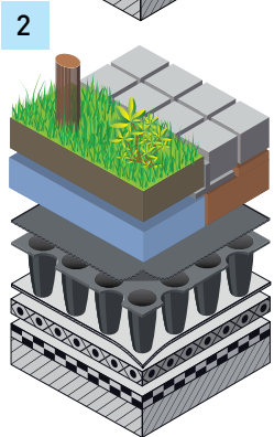
Opbouw Nophadrain Extensief (1) en Intensief (2) Groendaksysteem
