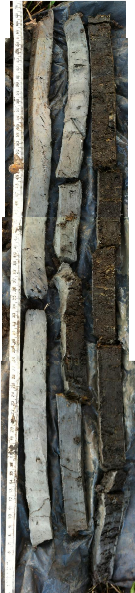
Boring 1: Overzicht boorkernen. Linksboven: maaiveld. Rechtsonder: 300 cm –Mv.
