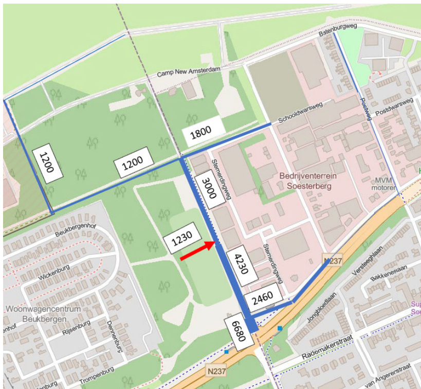
Figuur 3: Prognosecijfers in aantal motorvoertuigen per etmaal in 2032 inclusief het plan Sortie 16
