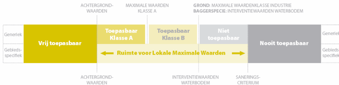
Figuur 5.6 Normstelling voor toepassen van grond en baggerspecie in oppervlaktewater in het generieke en gebiedsspecifieke kader
