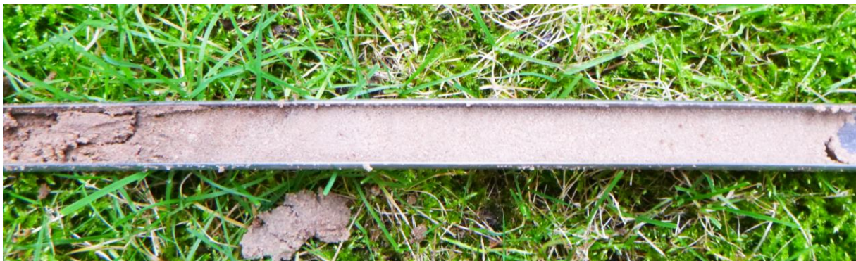
Figuur 18: Foto van het pakket schoon matig fijn zand dat op de boorpunten 5 en 8 onder de toplaag is aangetroffen.
