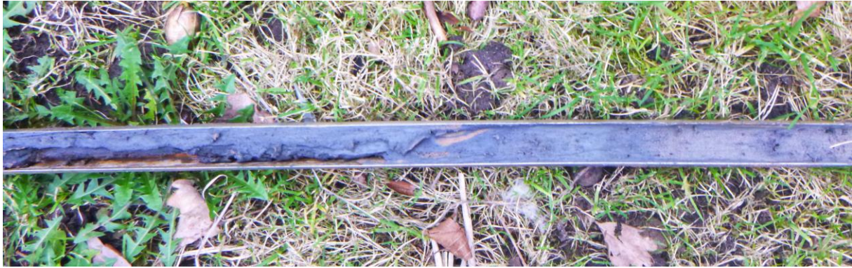
Figuur 19: Foto van boring 3 met links venige klei, rechts van het midden door kleilaagjes onderbroken zand en rechts zand.
