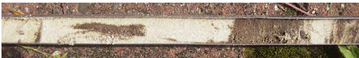
Figuur 13: Foto van boring 1 met het vergraven zandpakket zoals dat ook in boring 2 t/m 5 is aangetroffen.
