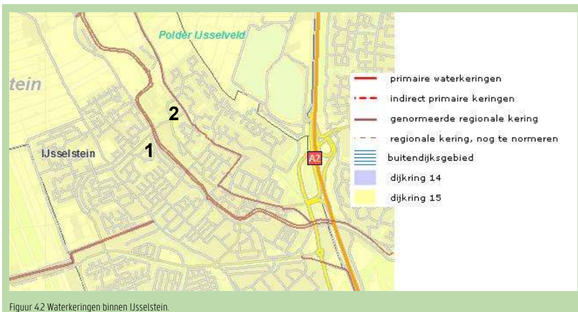
Figuur 4.2 Waterkeringen binnen IJsselstein.
