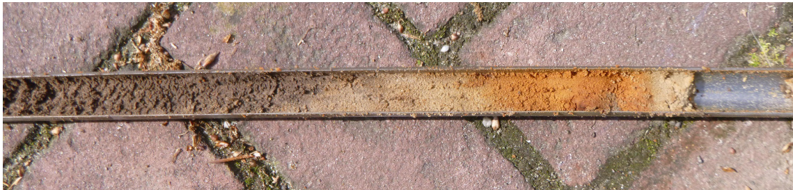
Figuur 7: Woudenberg, Zegheweg 8: Foto van de oxidatie-vlekken waardoor de C-horizont (rechts) binnen het plangebied wordt gekenmerkt (in dit geval op boorpunt 5).
