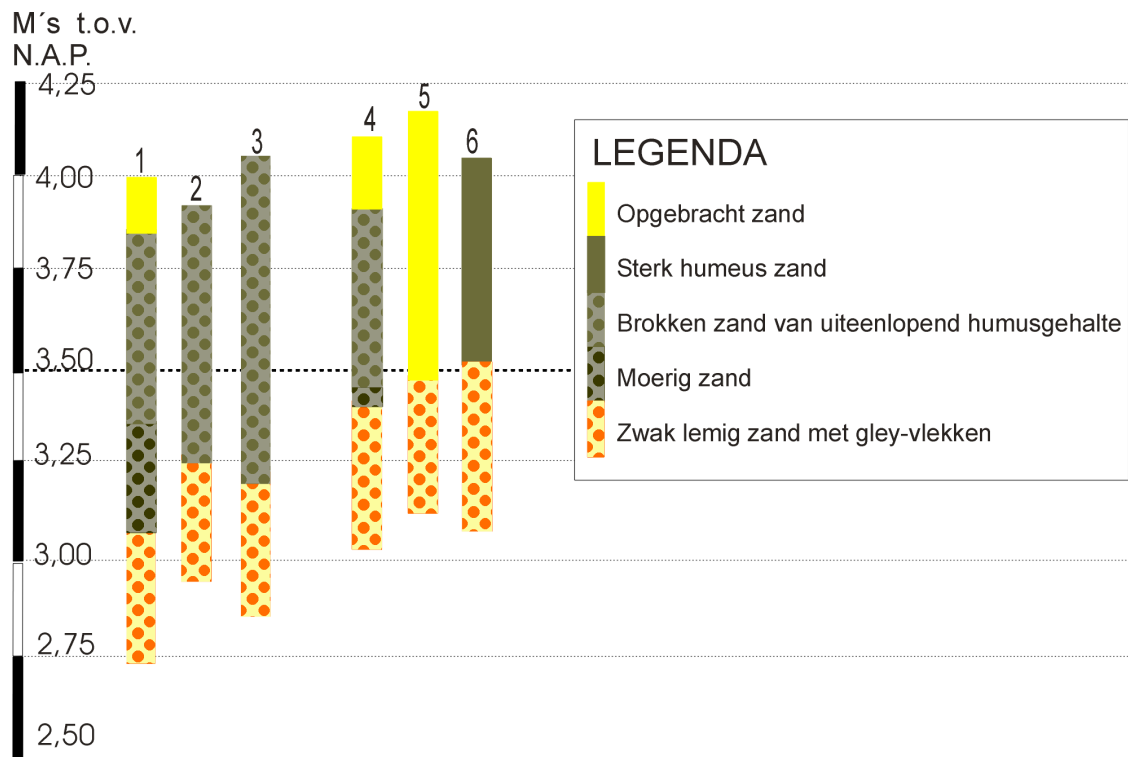
Figuur 8: Woudenberg, Zegheweg 8: De resultaten van het booronderzoek weergegeven als boorstaten.
