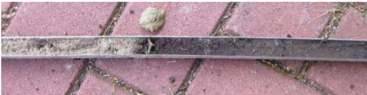
Figuur 18: Foto van het pakket zwak moerig humusrijk zand zoals dit op de boorpunten 6 tot en met 10 is aangetroffen
