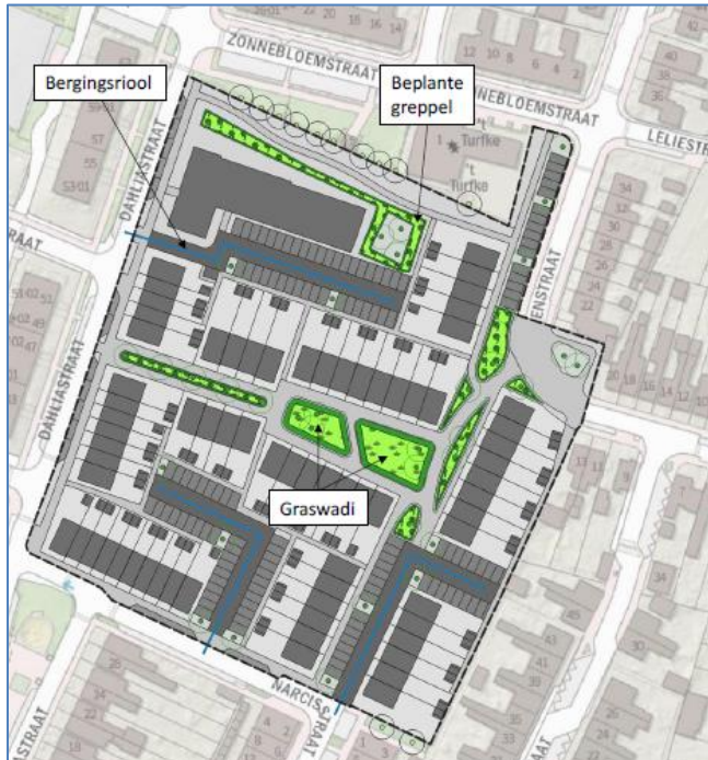
Figuur 4-1: schetsontwerp 25 mm waterberging
