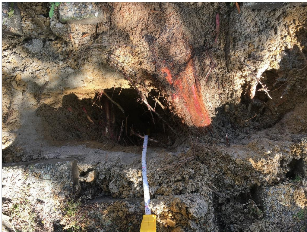
Afbeelding 24: - Maaiveld wortel \Phi 10 cm - 20 cm-mv: wortel \Phi 7 cm - 0-30 cm: fijne opnamewortels - vanaf 35 cm-mv: verdichte puinlaag
