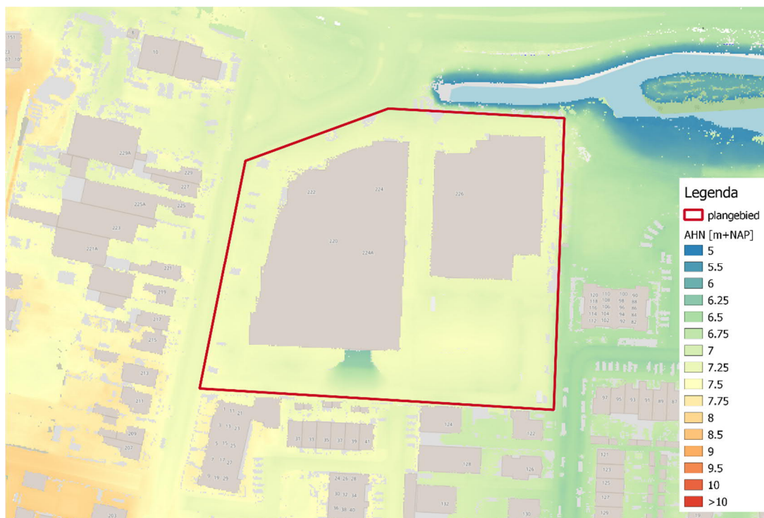
Figuur 2 Maaiveldhoogte in en rondom het plangebied (Bron: AHN3)
