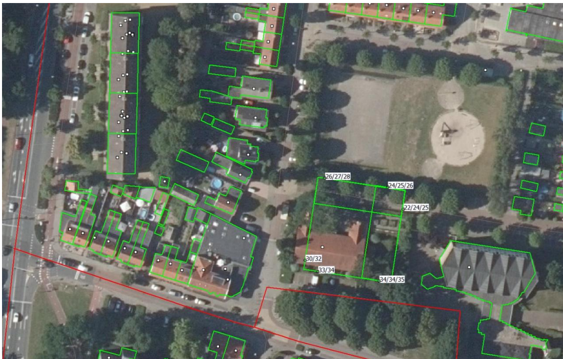
Figuur 4-1 Toetsingswaarde ( L_{den} ) in dB, door verkeer op de Rondweg West inclusief correctie
