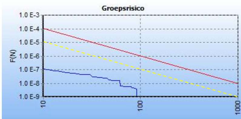
Figuur 5.2 FN curve voor leiding W-523-03 voor de kilometer tussen stationing 1770.00 en stationing 2770.00
