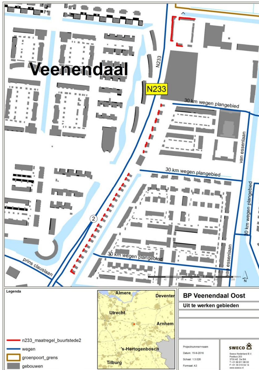
Figuur 4.6 Dove gevels voor de N233 bij een geluidsbelasting groter dan 53 dB inclusief aftrek van 2, 3 en 4 dB conform artikel 3.4 RMG 2012
