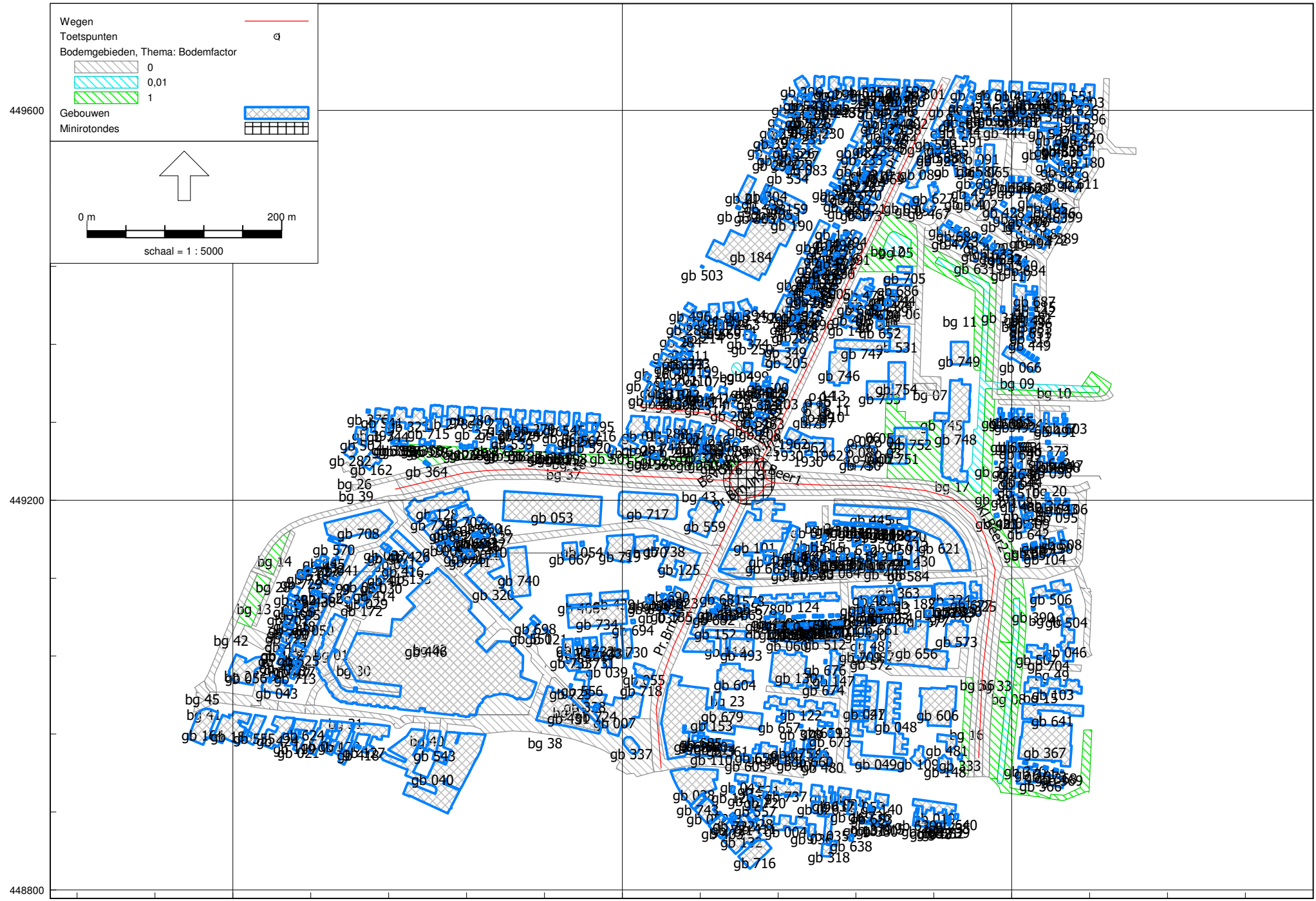
166400 166800 167200 Wegverkeerslawaaï - RMW-2012, [Boveneind Veenendaal R3 - tussentijdse situatie met verschoven gebouw] , Geomilieu V4.30
