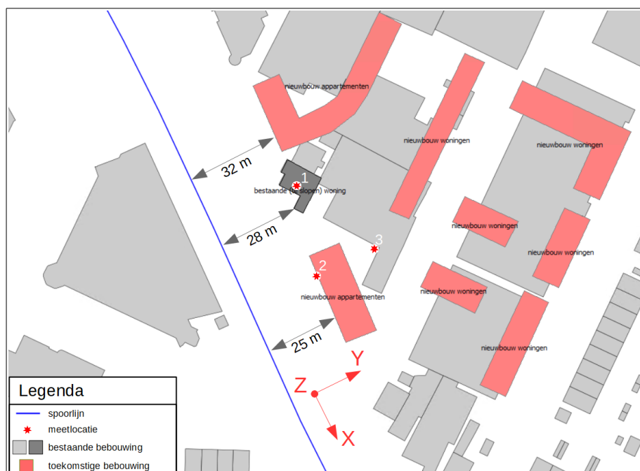
f5.1 Schematische weergave van de meetlocaties in de bestaande (en toekomstige) omgeving
