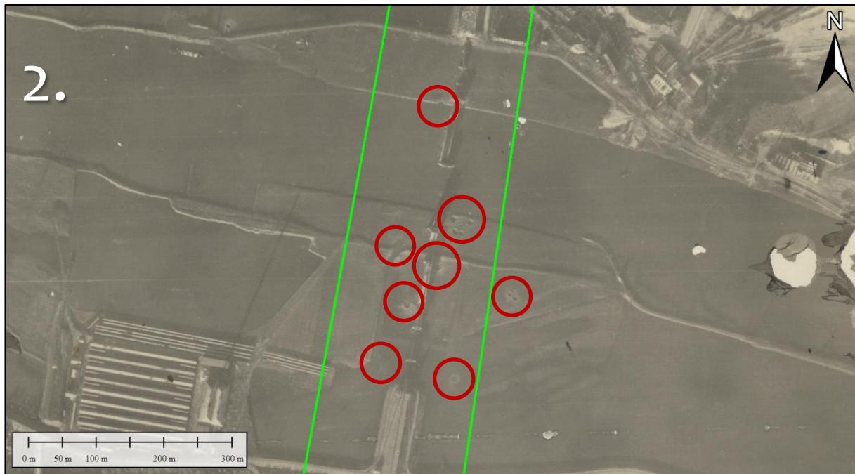
Figuur 45. De spoorbrug bij Rhenen op 23 december 1944. De vernielingen aangericht door de bombardementen zijn goed zichtbaar, net als de vele kraters die ze hebben achtergelaten. De meeste hiervan zijn rood omcirkeld. In totaal zijn er 18 kraters waargenomen rondom de spoorbrug, geteld met behulp van meerdere luchtfoto's. Minimaal één bom moet een voltreffer op de brug zijn geweest en er zijn zoals vermeld in de tabel met oorlogshandelingen van Rhenen nog twee blindgangers gevonden van dit bombardement. Aangezien er in totaal 34 bommen zijn afgeworpen betekent dat de overige 13 in het water zijn gevallen en daar al dan niet gedetoneerd zijn, ook op de brug gedetoneerd zijn, of als achtergebleven CE nog ergens in de bodem rondom de brug aanwezig zijn. Luchtfotonummer 3082.
