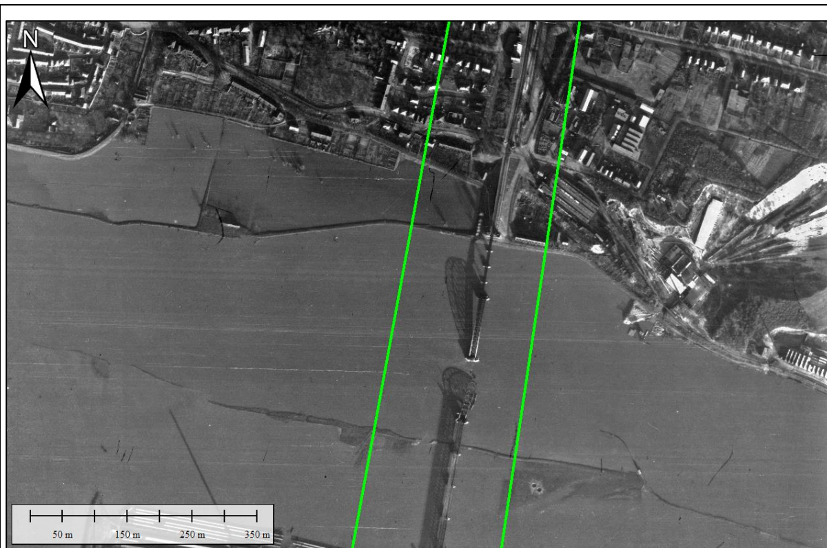
Figuur 21. De gebombardeerde spoorbrug op 26 november 1944. De brug is inderdaad geraakt op of nabij de middelste pijler. In de omgeving zijn een paar inslagkraters te zien, hoewel de uiterwaarden op deze datum grotendeels onder water staan. Luchtfotonummer 4059.
