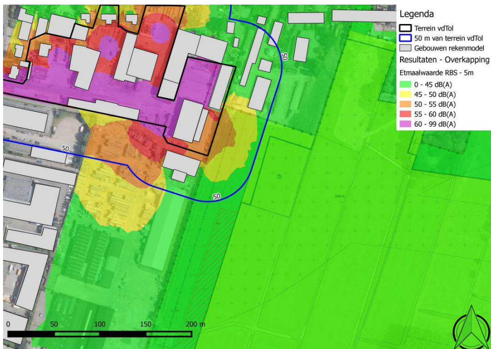
Figuur 5.8 Resultaten RBS op 5 m hoogte, inclusief overkapping.
