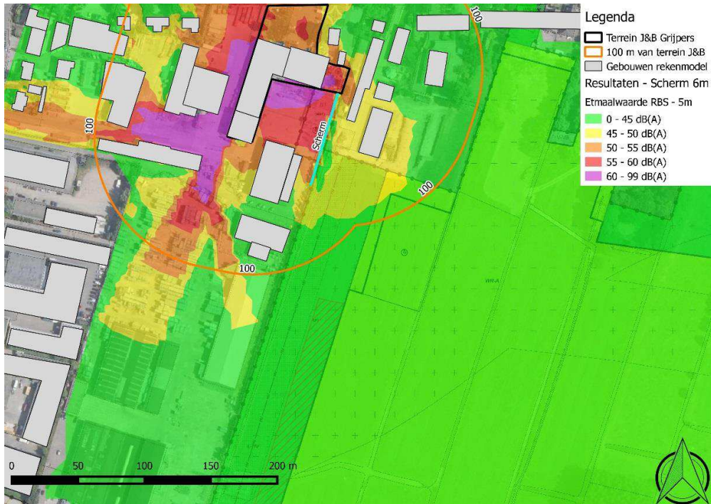
Figuur III.1 Geluidbelasting J&B Grippers met maatregel v.d. Tol - scherm 6 meter - rekenhoogte 5 meter
