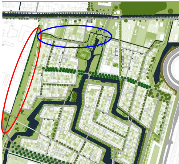
Figuur 3.1 overzicht van de beoogde nieuwe inrichting van het plangebied. De moerassloot is daarbij rood en blauw gemarkeerd. Het blauwe deel wordt ingericht als hoogwatersloot, waarbij slechts delen geschikt worden gemaakt voor de Grote modderkruiper. Het rode deel wordt geheel moerassloot.
