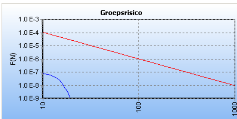
5.2 Figuur 5.2 FN curve voor W-506-01 van N.V. Nederlandse Gasunie voor de kilometer tussen stationing 8844.00 en stationing 9844.00
