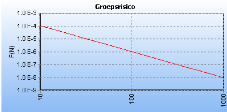
5.3 Figuur 5.3 FN curve voor W-501-02 van N.V. Nederlandse Gasunie voor de kilometer tussen stationing 0.00 en stationing 1000.00
