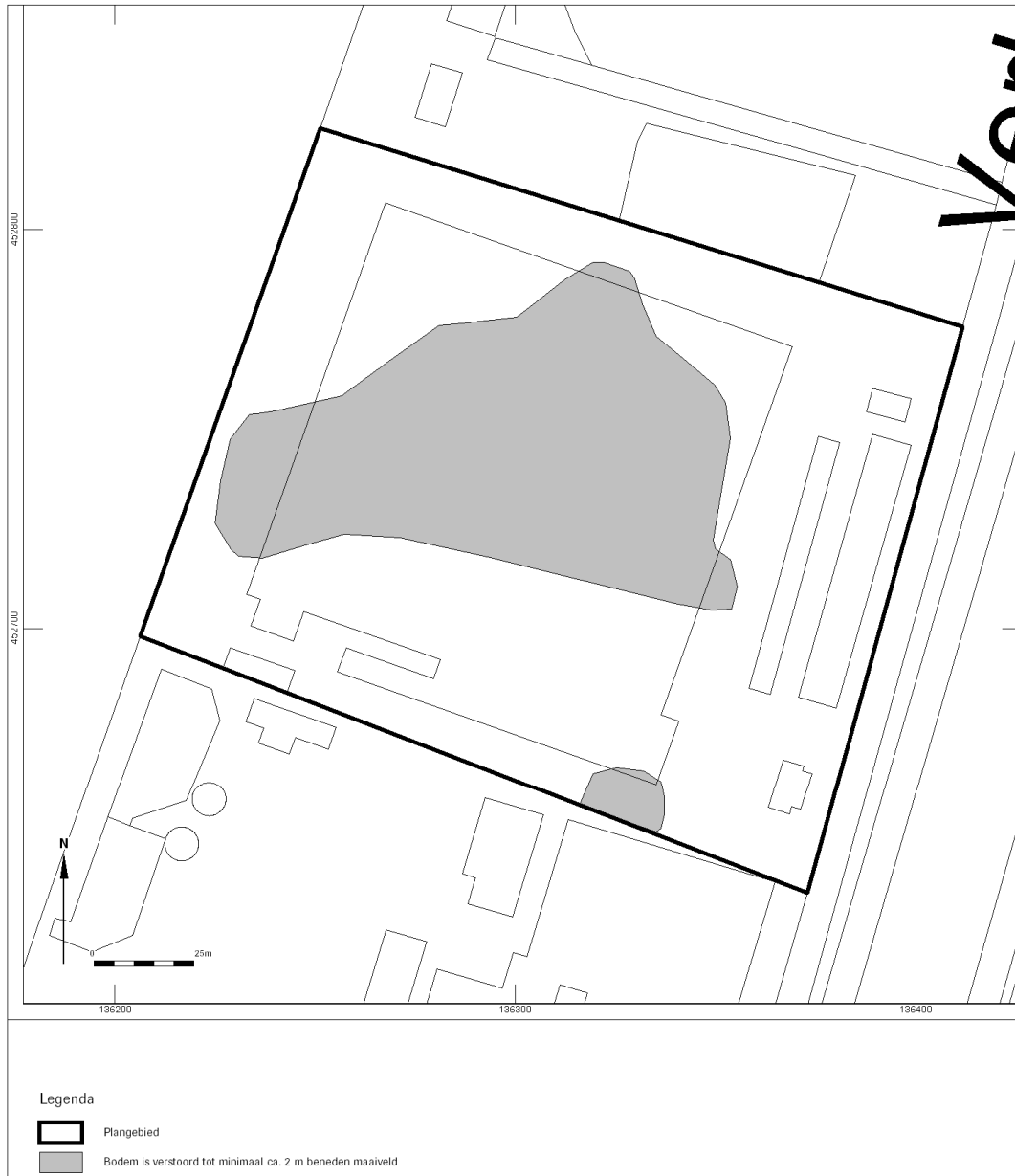
Afb. 5 Gedeelten van het terrein waar volgens het milieukundig bodemonderzoek de bodem verstoord is.
