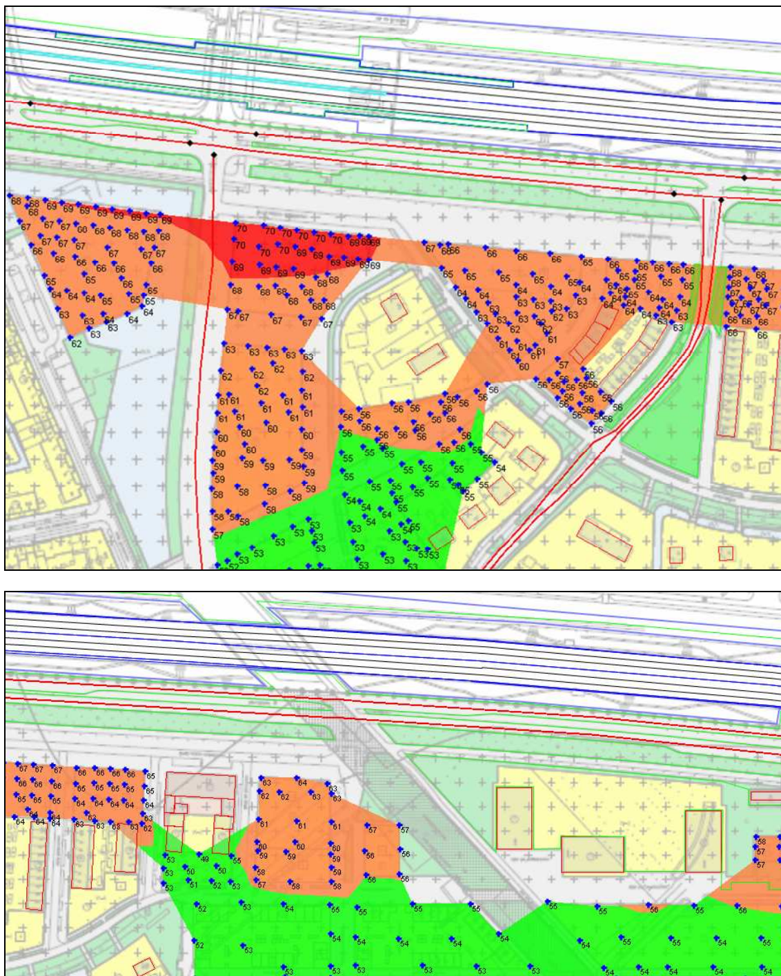
Figuur 9 : Hoogst berekende geluidsbelasting vanwege het spoor
