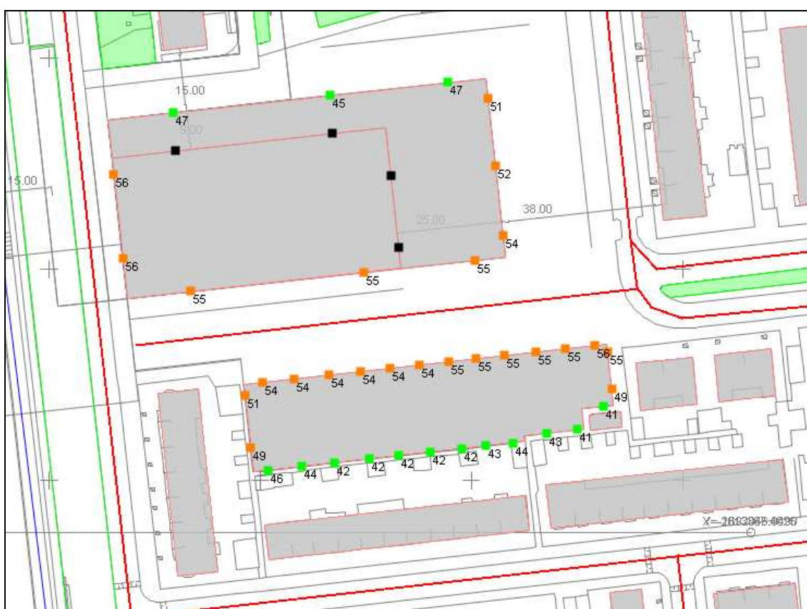
Figuur 10 : Hoogst berekende geluidsbelasting gecumuleerde geluidsniveau
