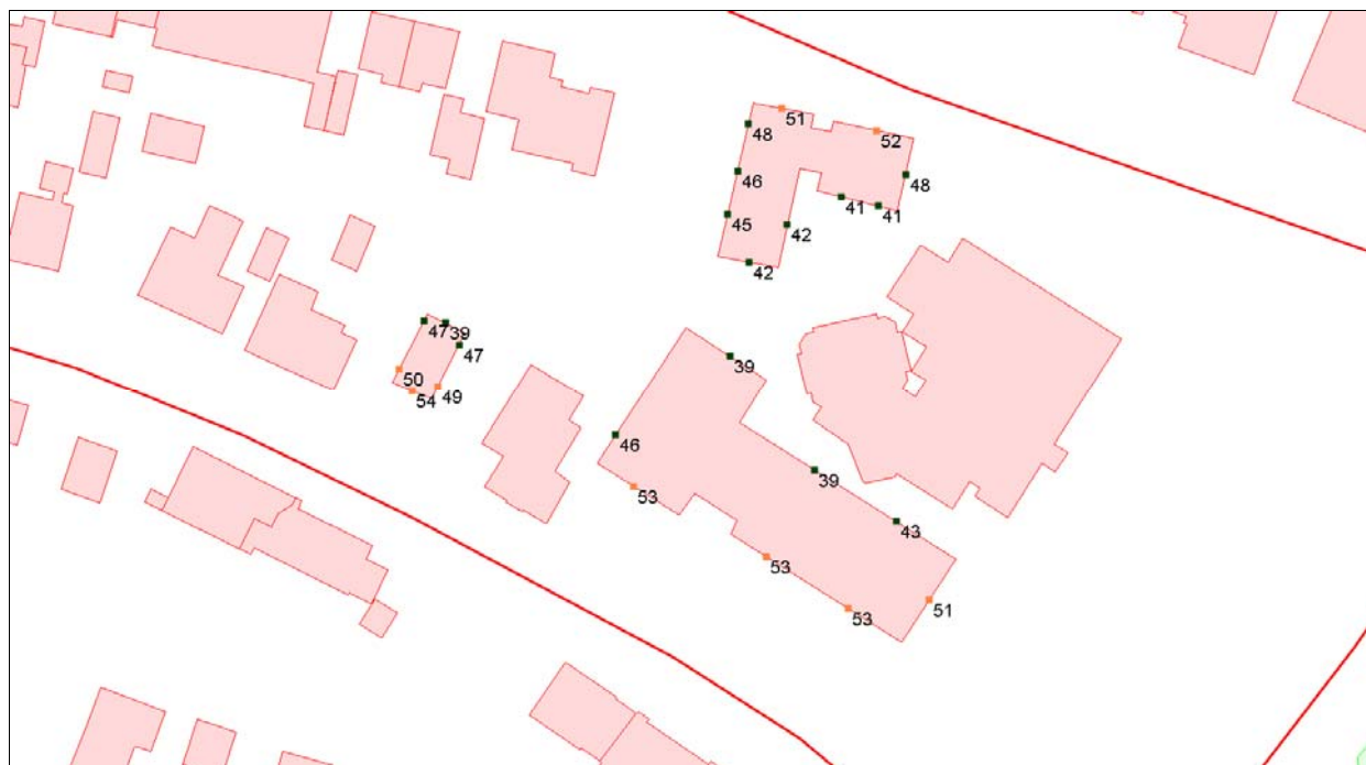
Figuur 4: Hoogst berekende gecumuleerde geluidsbelasting vanwege omliggende wegen
