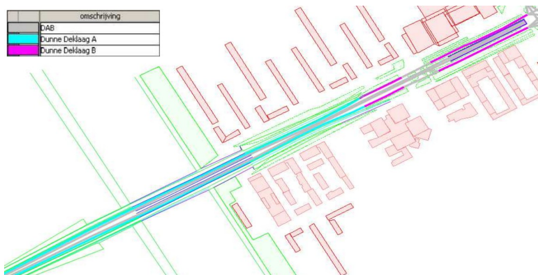
f4.3 Toe te passen wegdek Churchilllaan (Dunne Deklaag B gedeelte reeds aanwezig)
