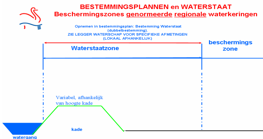
figuur 6 – principeprofiel beschermingszone waterstaatswerk (bron: HDSR- april 2011)
