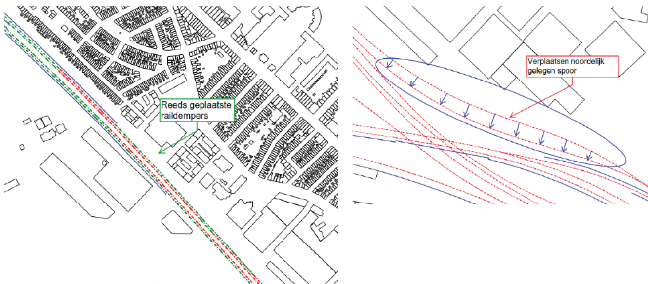
Figuur 6.1: Wjzigingen geluidregister spoor t.b.v. werkelijke situatie. Links: reeds geplaatste raildempers Rechts: verplaatst spoor.
