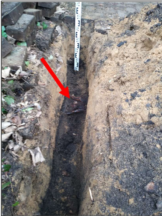
Afbeelding 9: Op 50 cm diepte zijn de eerste boomwortels van betekenis aangetroffen. In de bovenste lagen is slechts fijne beworteling aanwezig. De beworteling zit in de humusrijke laag die op 40 cm onder maaiveld begint. Deze humusrijke laag is circa 20 cm dik. Daarna gaat de bodem weer over in schralere grond. Met een boring tot 1 meter onder maaiveld is geen grondwater of beworteling aangetroffen. De werkzaamheden kunnen hier onder toezicht worden uitgevoerd. Voorwaarde is ook dat de bodem niet dieper wordt geroerd dan 40 cm om wortelschade te voorkomen.
