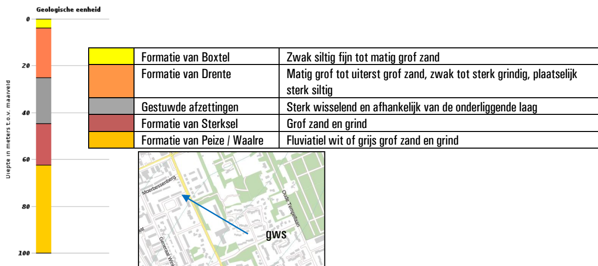
Figuur A: opbouw ondergrond.
