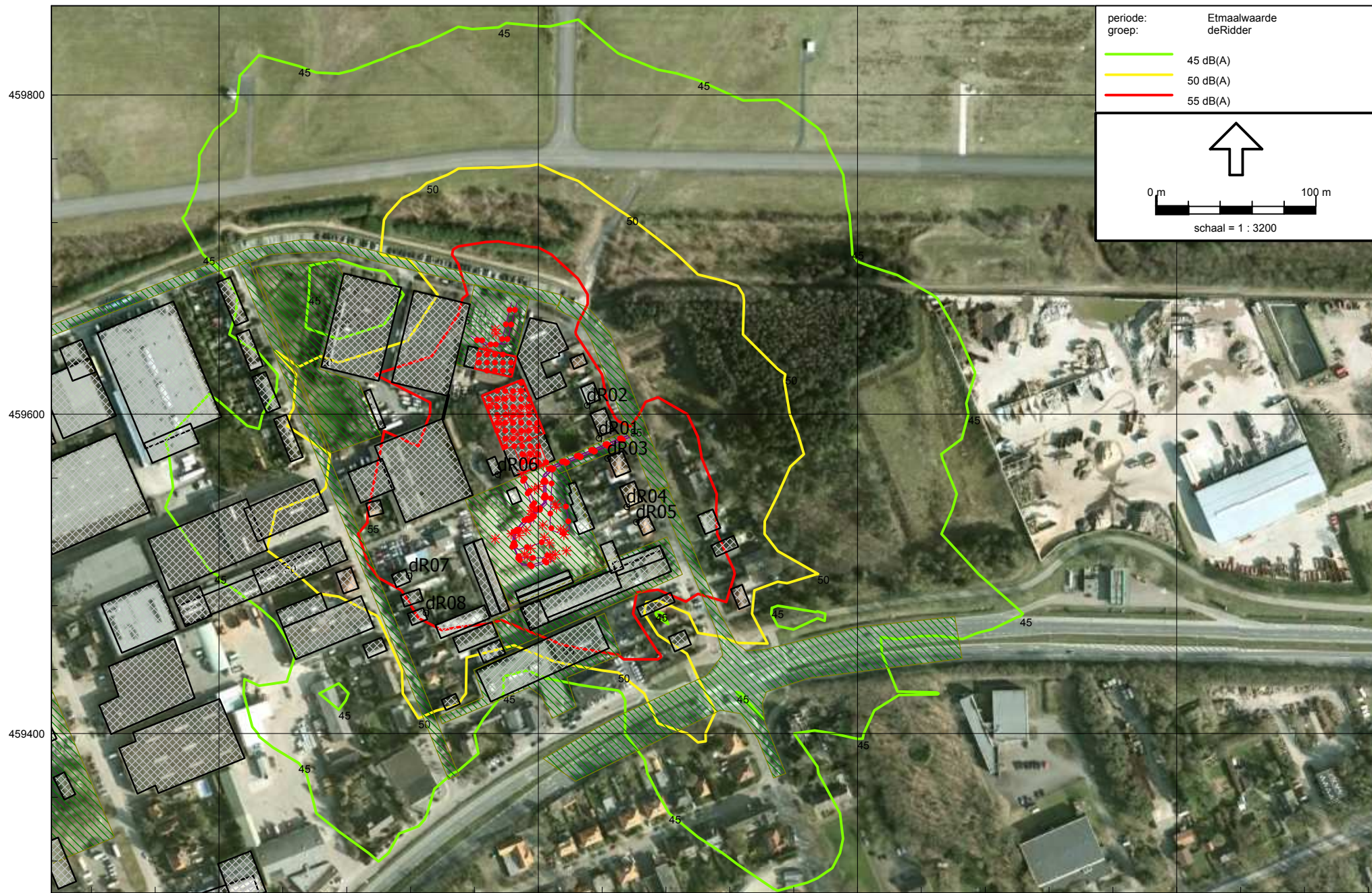
Figuur I.09 Geluidcontouren (etmaalwaarde - 5m hoogte)
