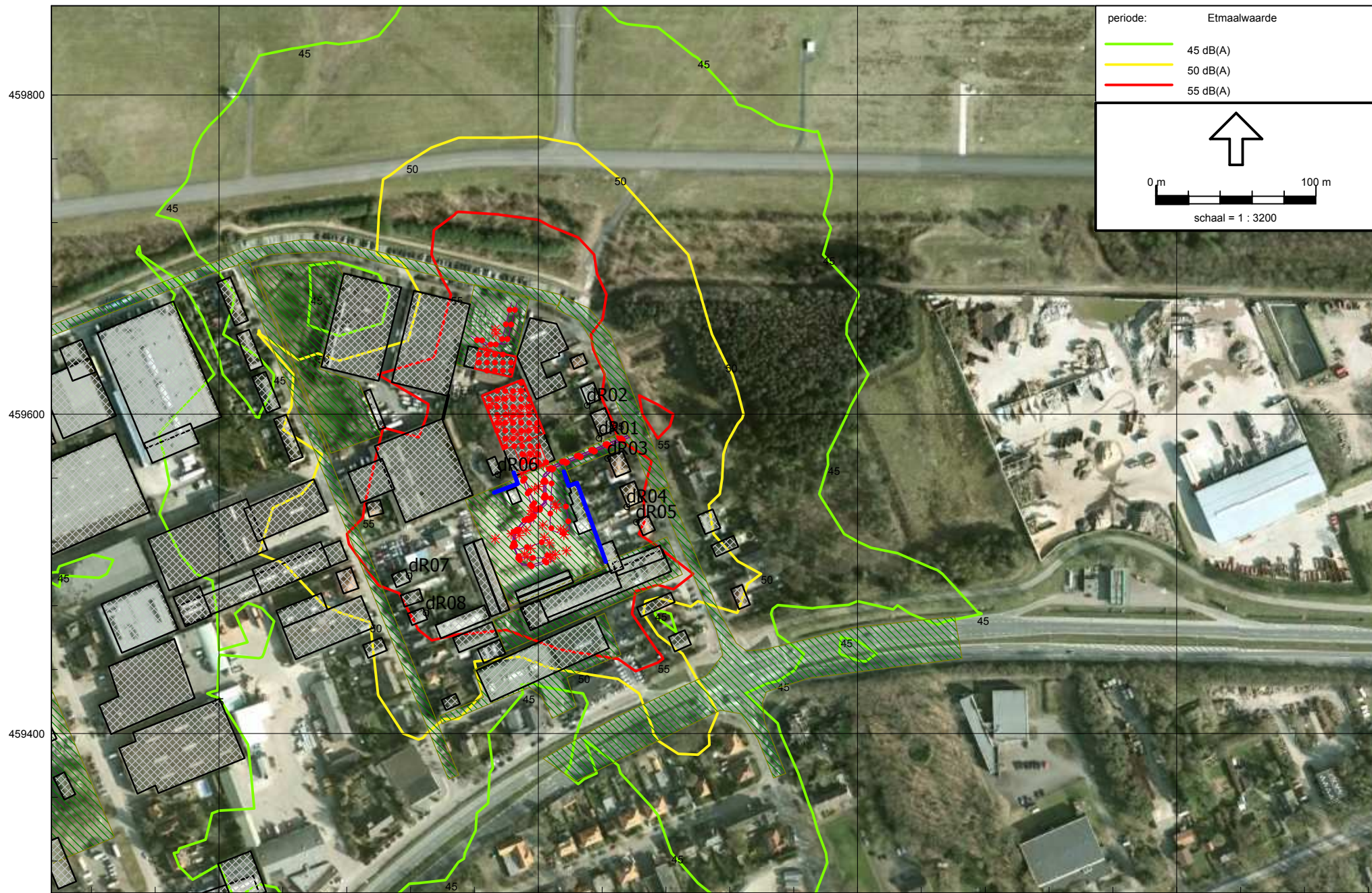
Figuur I.10 Geluidcontouren (etmaalwaarde - 5m hoogte) met bronmaatregelen en schermen
