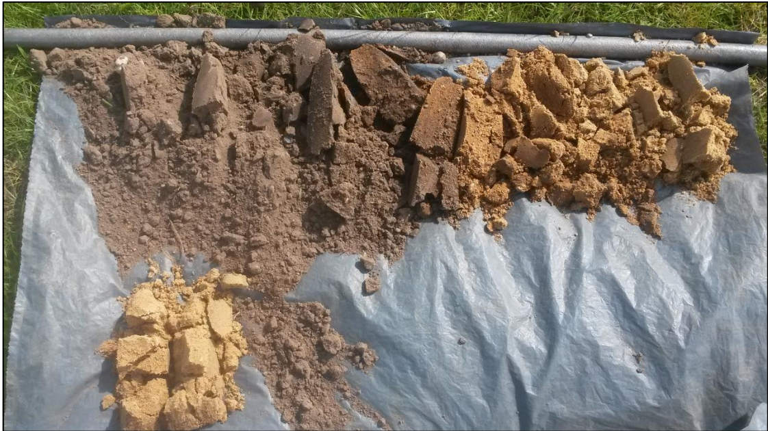
Figuur 7 Foto van boring 1: Ap-horizont (donkergrijszwart) op A/Bp-horizont (bruingrijs) op Bw-horizont (donkergeel) op C-horizont (geel).
