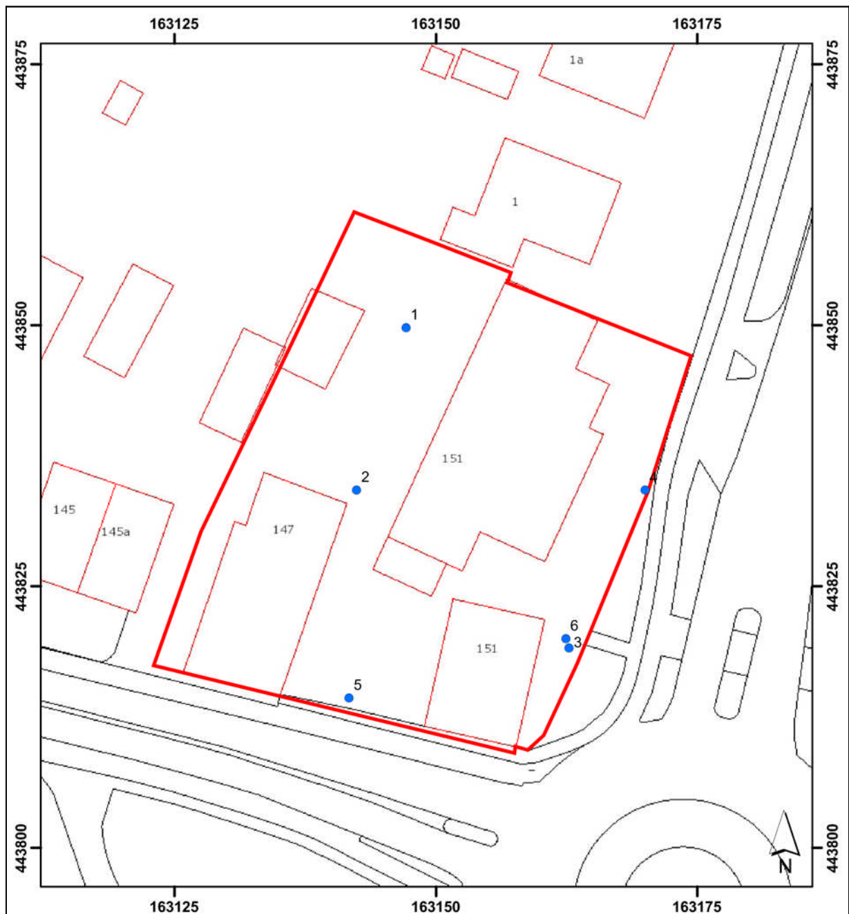
Afbeelding 12. De locaties van de boorpunten (in blauw), geprojecteerd op een uitsnede van de GBKN. Het plangebied is rood omkaderd. ©Topografische Dienst Kadaster, Emmen [2012]. Schaal 1: 500.
