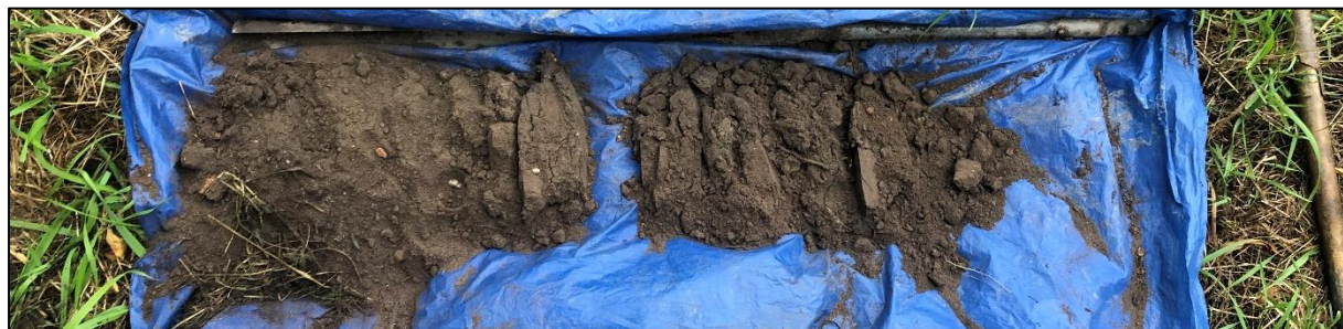
Een van de pogingen tot het uitvoeren van boring 4. Meermalen gestaakt op een diepte van maximaal 70 cm -Mv.
