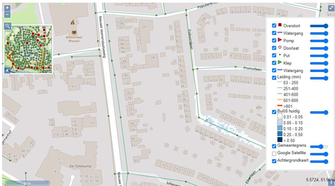
fig. 6 Water op straat bij een bui08
