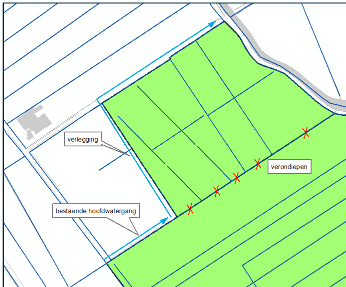
Figuur 14: Verleggen en verondiepen hoofdwatergang
