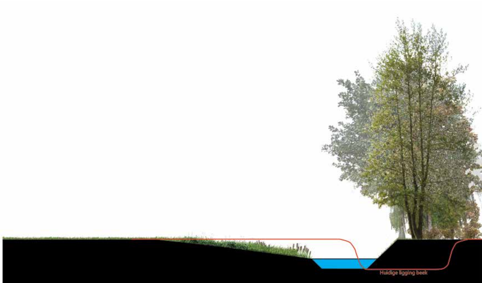
Principedoorsnede 2: waterprofiel aan oostzijde beekzone, waterbak aan oostzijde waterprofiel
