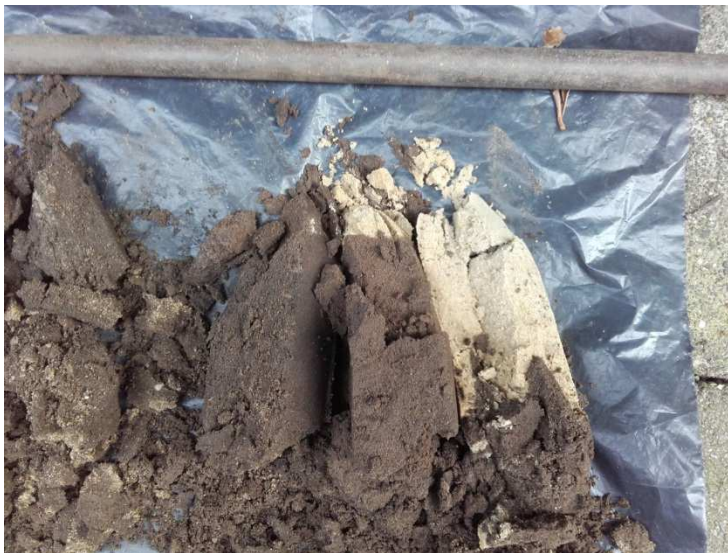
Afbeelding 8 Foto van het bodemprofiel in boring 13, met een scherpe grens tussen bovengrond en onderliggend dekzand. Bron: Vestigia (22-09-2016).
