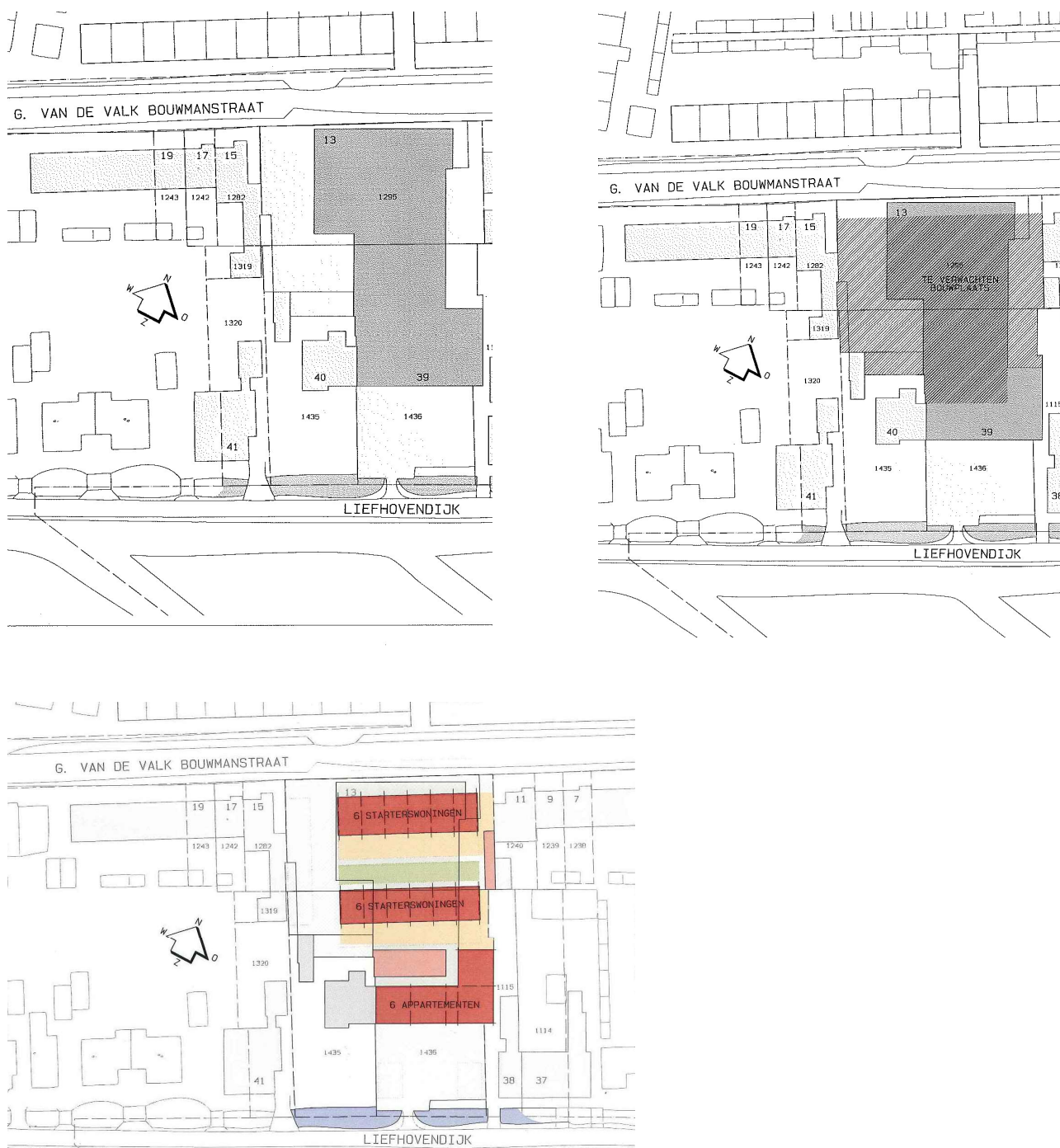
Figuur 4: De huidige (linksboven) en toekomstige situatie (linksonder). Op de schets rechtsboven de te verwachten bouwplaats. Bron: Arco Architecten BNA.
