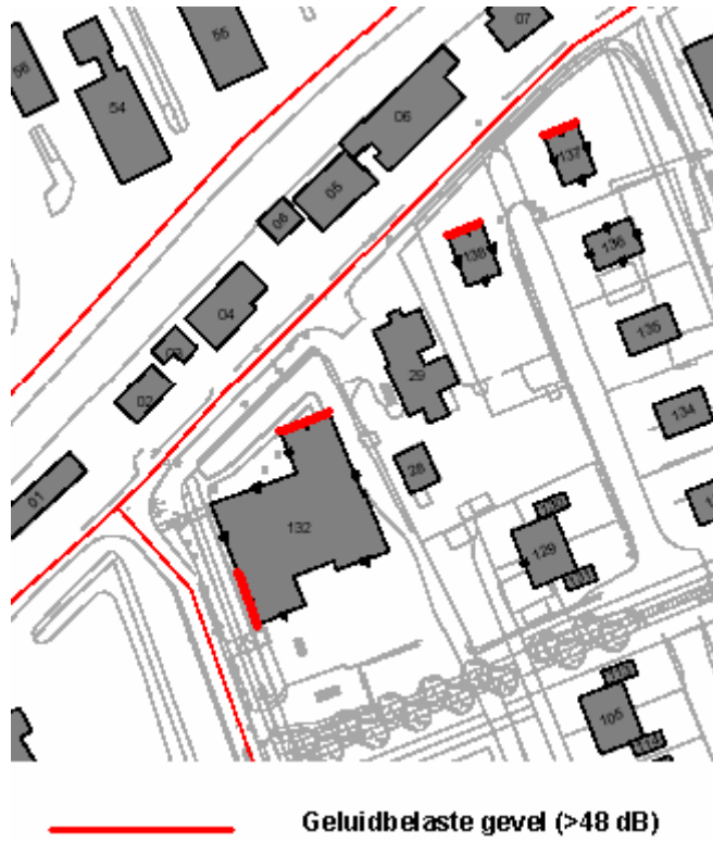
Figuur 5.1 Overzicht geluidsbelaste gevels
