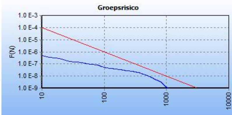
5.3 Figuur 5.3 FN curve voor 5322_leiding-W-520-06-deel-1 van N.V. Nederlandse Gasunie voor de kilometer tussen stationing 600.00 en stationing 1600.00
